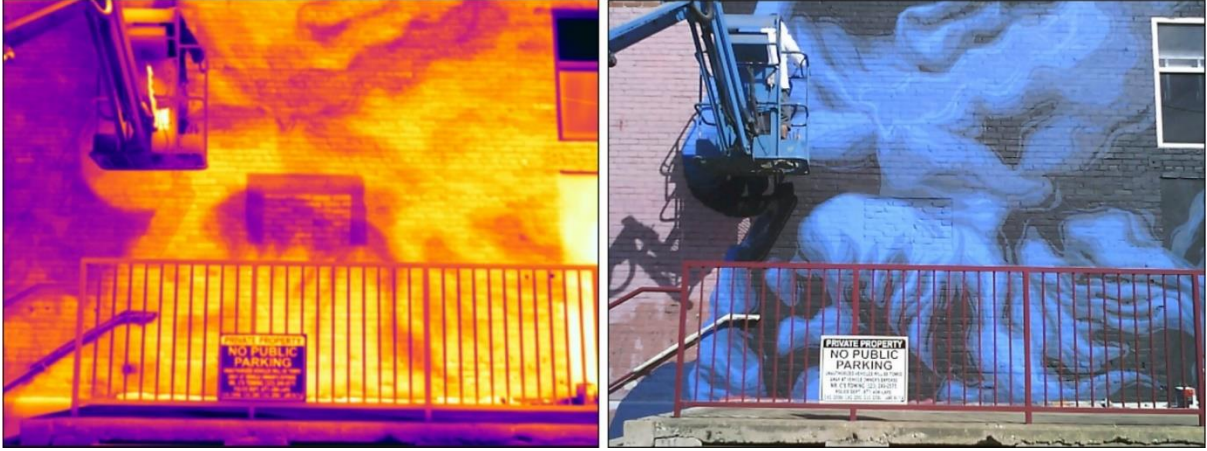
شكل ٦: صورة توضح تأثير الطلاء البارد وقدرته على عكس الحرارة، باستخدام كاميرا حرارية التقطت دوامات من الأصفر والبرتقالي والأرجواني وهي الانبعاثات الناتجة عن الجدارية. المصدر: https://luskin.ucla.edu/street-art-meets-climate-science-in-the-big-blue-face-of-zeus
