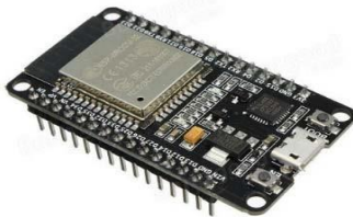
Figure 2: ESP32 Devkit V1 MCU
