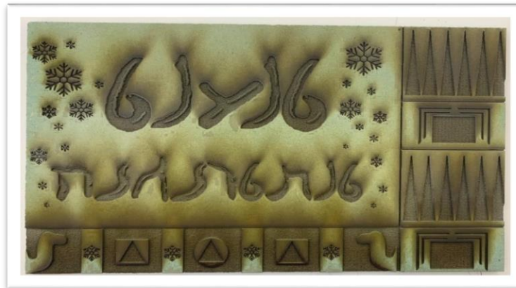
الشكل رقم ١٥ . قالب الطباعة بعد حفر التصميم على " الخشب " بالليزر بعد عمل التصميم.
