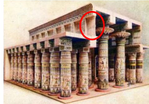
شكل (٣) نوافذ الإضاءة العلوية بين فرق مناسيب السقف (Sugár, Leczovics, & Horkai, 2017)
