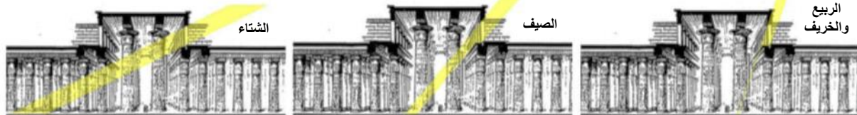
شكل (٢) زوايا أشعة الشمس التي تدخل لبهو الأعمدة من فتحات الإضاءة العلوية خلال فصول السنة المختلفة (Ramzy, 2013)
