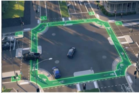
شكل (١٦) تمييز أماكن حركة المشاة والدراجات بنوعية من الأرضيات والألوان على المسارات لتهدئة الحركة أثناء العبور لتقليل الأخطار المحتملة. المصدر (McMillan, A., 2019).
