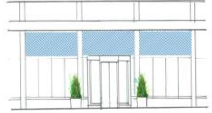
شكل (٥): دمج الخلايا الفوتوفولتية مع الفتحات المعمارية للواجهات [10].
