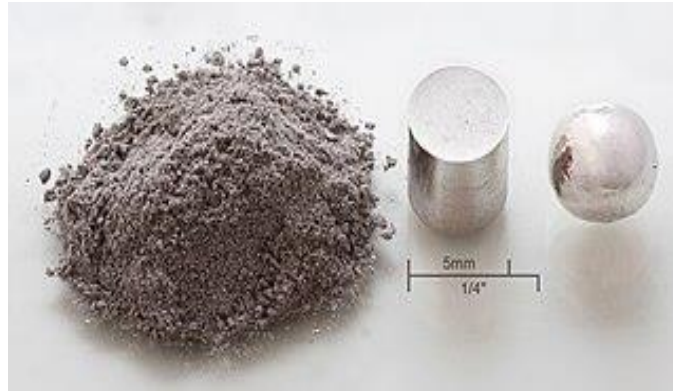
شكل (٩) يوضح صورة لمساحيق المعادن قبل وبعد التلييد
