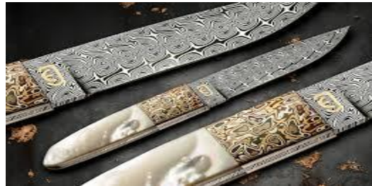
شكل (٥) صورة لنموذج من السيوف والخناجر المصنوع بتقنية الدمج الميكانيكي المعدني
