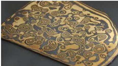
شكل (٦) توضح سطح معدني منقذ بتقنية الدمج الميكانيكي المعدني
