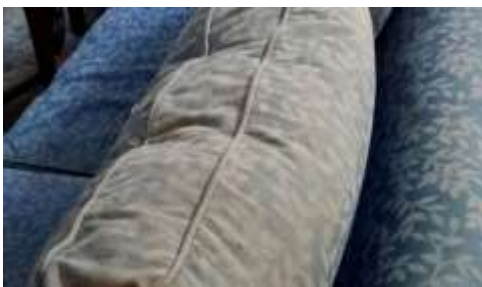
صورة (8) – توضح أثر أشعة الشمس علي قماش تنجيد الأريكة ، حيث يتضح فقدان الجزء الأكثر عرضة لأشعة الشمس ( ظهر المساند) إلي اللون وأيضاً ضعف النسيج مقارنة بباقي أجزاء الأريكة الأقل تعرضاً لأشعة الشمس .
