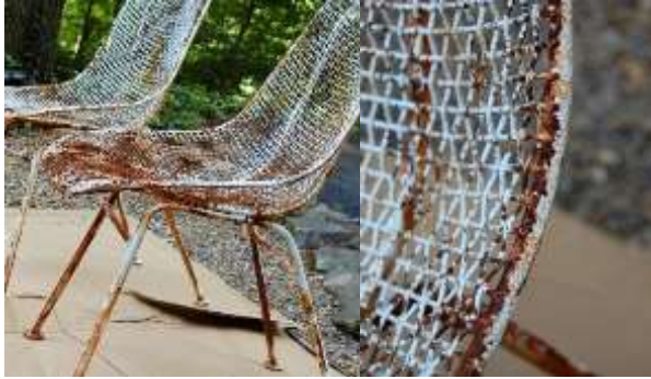
صورة (13) - توضح صدأ الأثاث المعدني نتيجة للرطوبة
