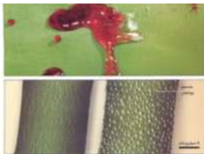
صورة (16) – توضح نسيج نانوي من القطن طارد للماء ( أعلى الصورة ) – حيث تبقى قطرات الماء على السطح ولا يمتصها خيط النسيج كما بصورة الخيط المعالج على يمين الصورة من أسفل – بينما يتشربها الخيط الغير معالج على يسار الصورة من أسفل .
