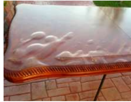
صورة (12) - توضح أثر المياه على سطح الخشب / قشرة السطح حيث أدت إلى ارتفاعه وانفصاله عن قرصة المنضدة
