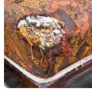
صورة (9) - توضح اهتراء الأقمشة نتيجة تعرضها لأشعة الشمس والحرارة.
