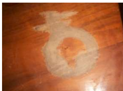
صورة ( 21 ) - توضح تلف سطح الخشب نتيجة لإزالة آثار الكوب باستخدام منظف منزلي غير مناسب لسطح الخشب .
