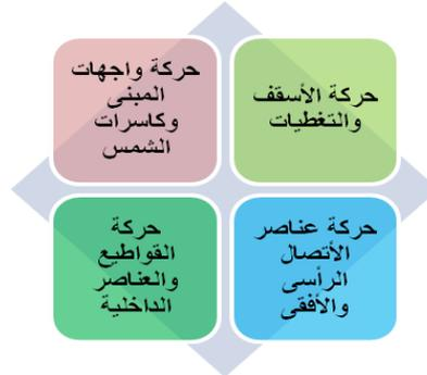
شكل (٥) يوضح أجزاء المبنى التى تتحرك حركة جزئية
