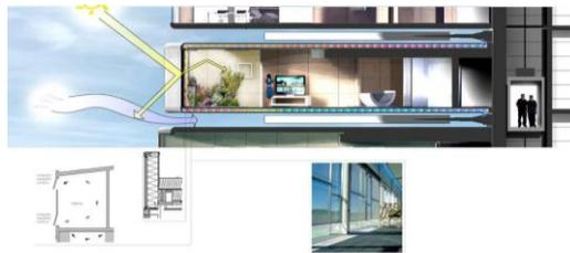
شكل (٣٩) يوضح استخدام الطاقة الشمسية وطاقة الرياح بالمبنى
