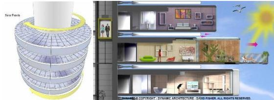
شكل (٤١) يوضح استخدام الطاقة الشمسية في توليد الكهرباء عن طريق الخلايا الكهروضوئية على أسطح أدوار المبنى بالإضافة إلى إستخدامها في الإضاءة الطبيعيه والحمامات الشمسيه
