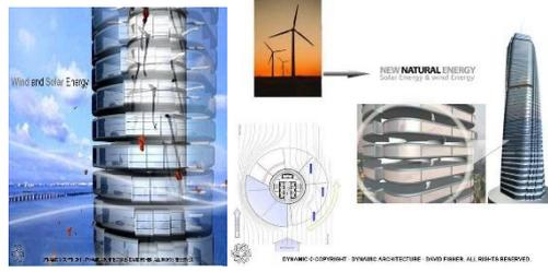
شكل (٤٠) يوضح إستخدام توربينات الرياح في المسافة البينية بين الأدوار من أجل توليد طاقة كهربائية للمبنى
