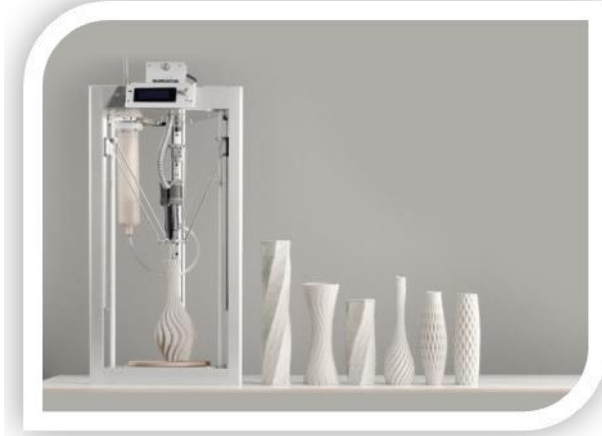
صورة (١٠) توضح مادة السيراميك اثناء الطباعة ونماذج بعد الطباعة
