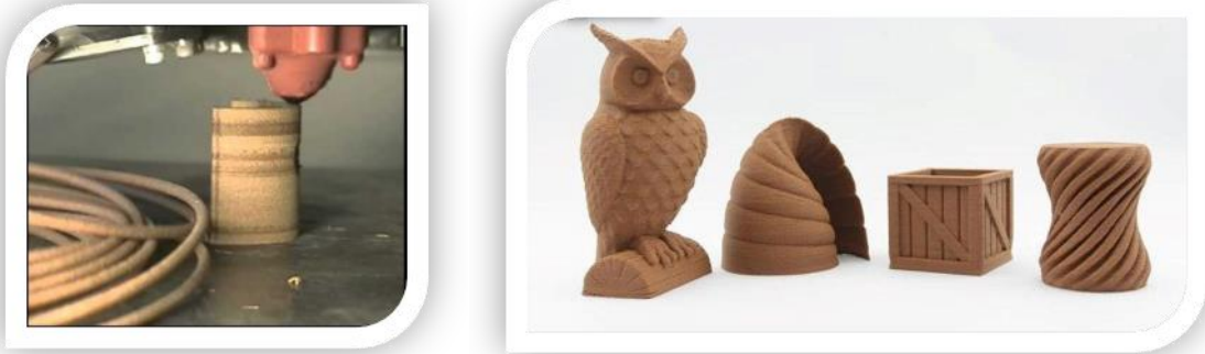
صورة (٨،٧) توضح شكل مادة ال LAY WOOD وبعض نماذج المطبوعة بها
