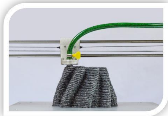
صورة (١٢،١١) توضح مادة الورق اثناء الطباعة ونماذج بعد الطباعة
