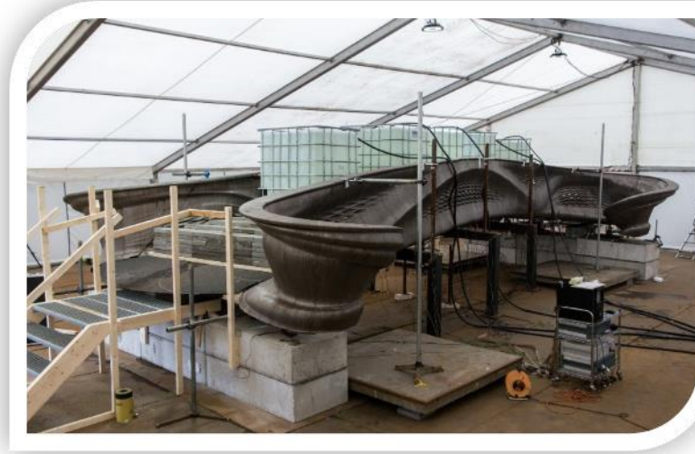
صورة (٢٣) أثناء اختبار الأحمال للجسر
