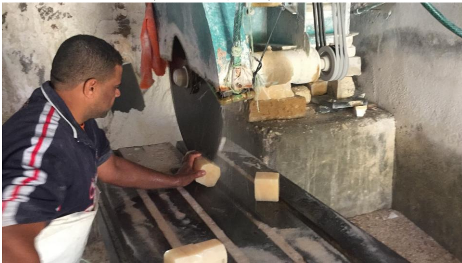
شكل ٧: مراحل تقطيع حجر الالباستر بالمقاس المطلوب
