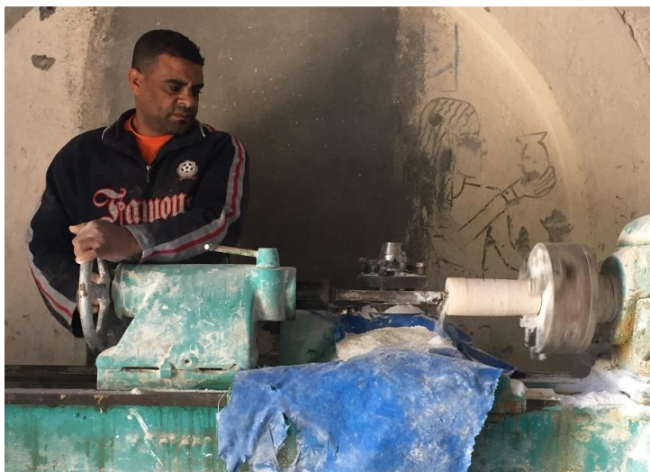
شكل ٨ : توضح مرحله الخراطة علي الحجر بعد مرحله التقطيع
