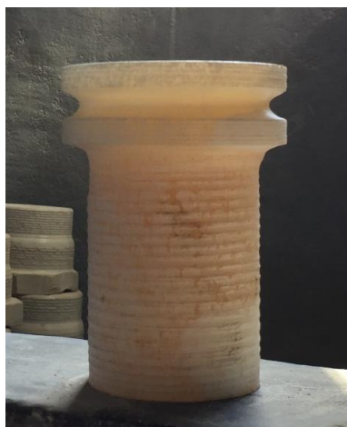
شكل ٩ : توضح الصورة بعد الانتهاء من مرحله الخراطة بورشة الالباستر
