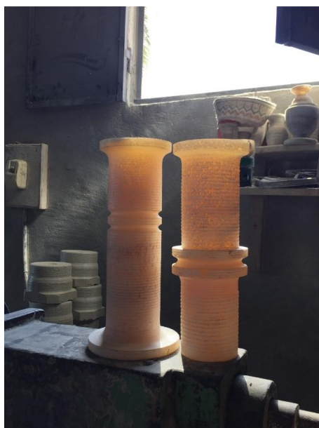
شكل ١٠ : الانتهاء من تصنيع العينات المطلوبه بخامه الالباستر وبالمقاسات المطلوبه
