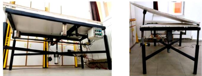
شكل ١٤ : طاولة الرسم الأوتوماتيكية والتي تم تصنيعها في ورش جامعة العلوم التطبيقية
