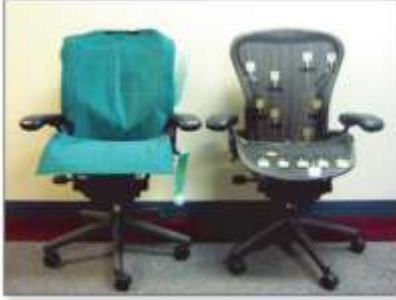
شكل (27) توزيع المجسات داخل الكرسي
