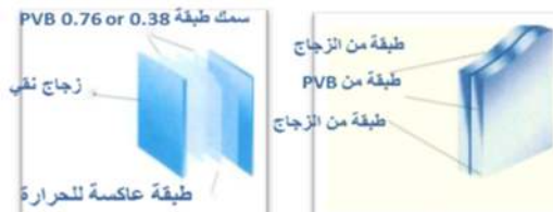
شكل 5 يوضح الطبقات المكونة للزجاج المتعدد الطبقات
