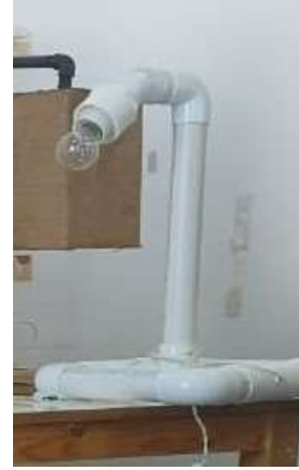
شكل (٧) وحدة إضاءة مكونة من مواسير PVC صرف صحي
