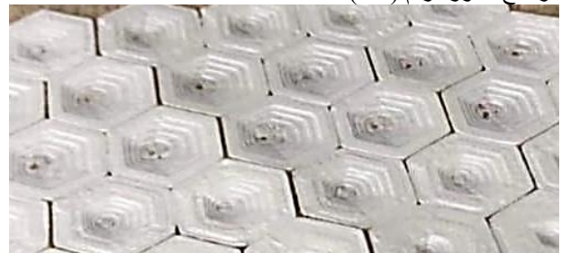
صورة (21) شكل العينة عند ارتفاع الفوهة 250ميكرون المصدر الباحث
