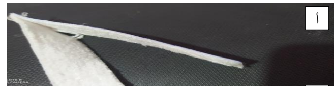
صورة (24) يوضح العينة (4) أقمشة تريكو سداء وبيرة بعد إجراء اختبار قوة التقشير عليها والسهم يوضح خلو طبقة الطباعة من أي وبيرة
