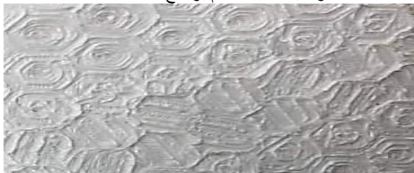
صورة (22) شكل العينة عند ارتفاع الفوهة لأقل من 200 ميكرون المصدر الباحث
