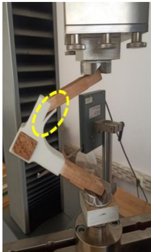
صورة (6) إختباروصلات مصنعة بتقنية الطباعة 3D ويوضح الضعف وعدم تحمل قوي الضغط في الإتجاه القطري (Antoni Nicolau et al, 2022, 2)
