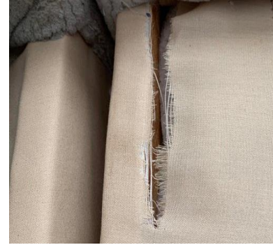
صورة (9) أحد أجزاء مقعد تعرض للتمزق بفعل الإحتكاك المصدر: (الباحث)
