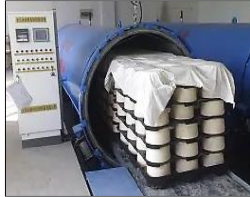
شكل (7) التثبيت الحراري (التبخير بالأوتوكلاف) للخيوط القطنية المدمجة بنوعها
