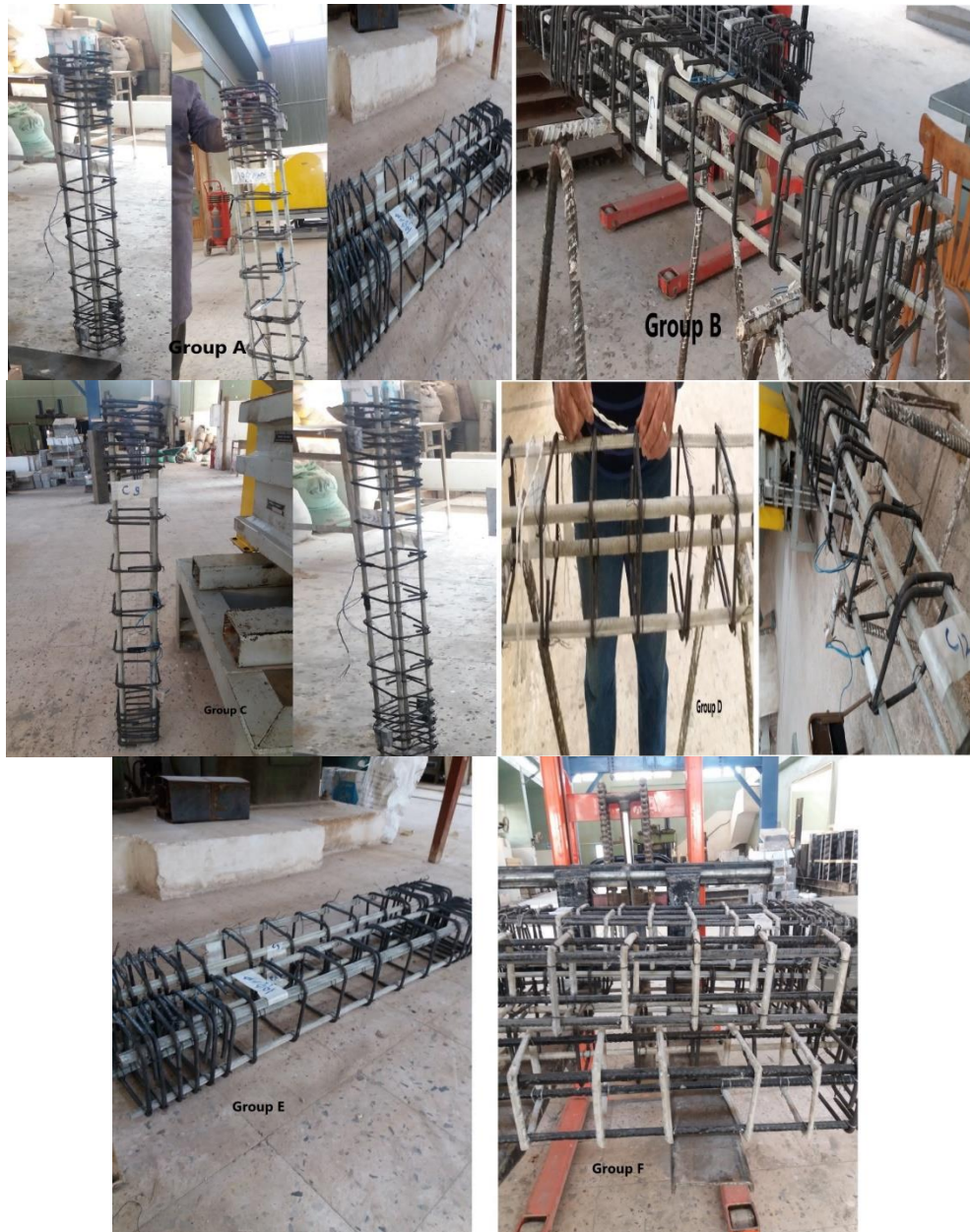
Fig. (7): Cages of Columns
