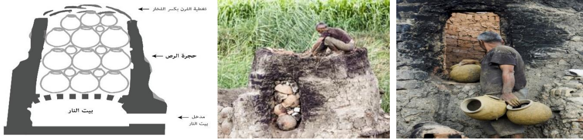
تشاول المنتجات لداخل الفرن أحد العاملين يقوم برص المنتجات تغطية قمة الفرن والفتحة الجانبية
