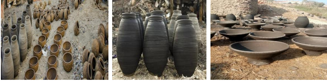
وضع المنتجات في الهواء الطلق لإتمام عملية التجفيف
