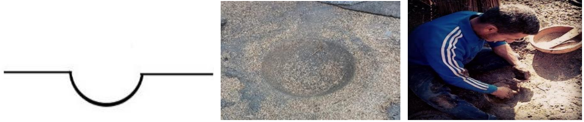
تجهيز الحفرة والتي تساهم في تشكيل الجدار الخارجي للمنتج
