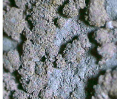
صورة رقم (١١): صورة ميكروسكوبية بقوة تكبير 25X لطبقات الصدأ والتآكل بغطاء الإناء. صورة رقم (١٢): جزء مفقود بغطاء الإناء ومدى ما بالإناء من تآكل، قوة تكبير 25X.
