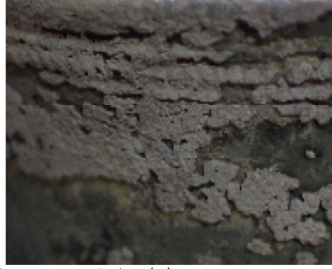
صورة رقم (٧): طبقة من نواتج الصدأ الهشة التي تغطي بدن الإناء. صورة رقم (٨): صورة ميكروسكوبية بقوة تكبير 25X لهذه الطبقة الهشة.
