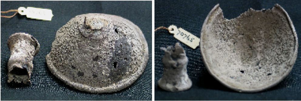
الصورتان رقمي (٩، ١٠): غطاء الإناء من الداخل والخارج تتضح قمته المنفصلة، وما به من أجزاء مفقودة وطبقات من الصدأ والتآكل.
