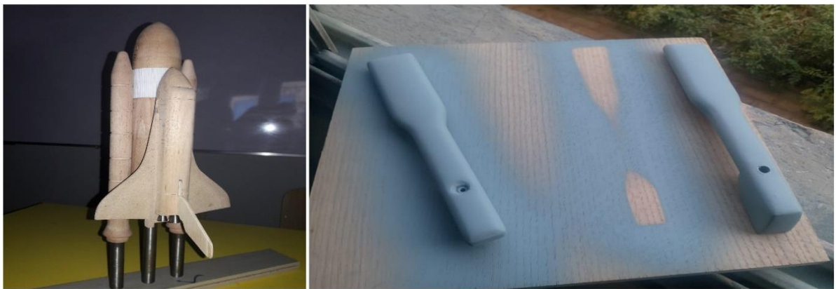
شكل ٢٧ : المكوك ومكواة الشعر بعد دهانهم بطبقة المعجون وتنعيم السطح بالصفرة
