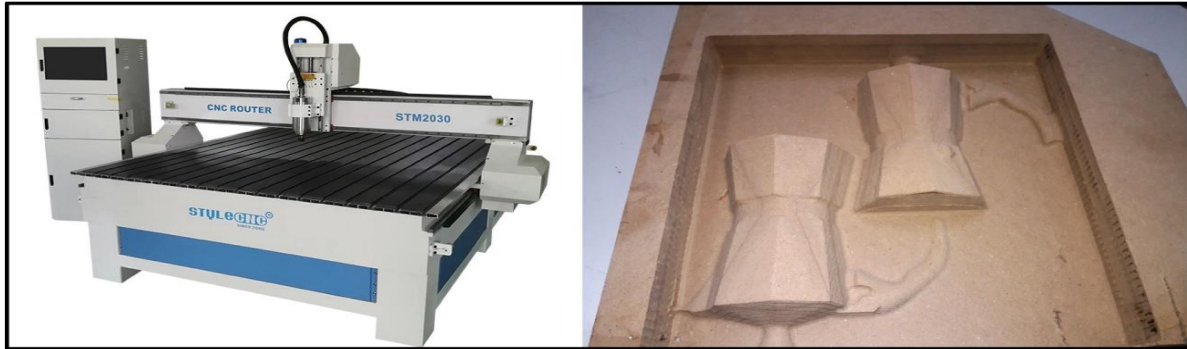
شكل ٧ : يوضح ماكينة حفر cnc
