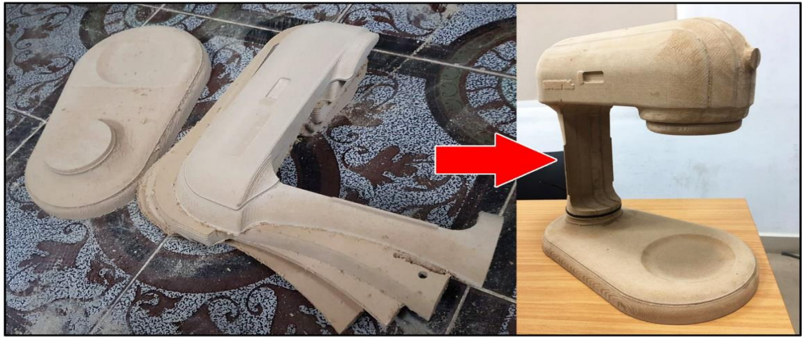
شكل ٢٣ : العجان بعد حفره cnc وتجميعه ولصقة
