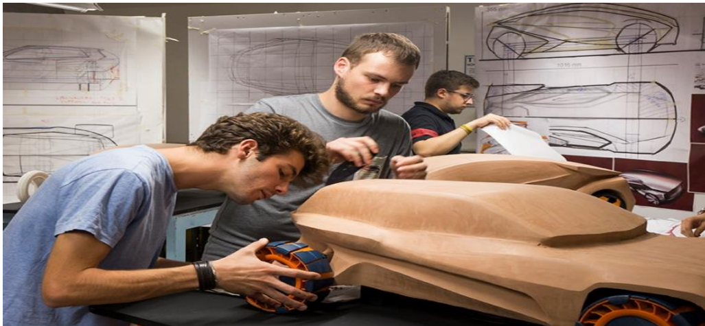
شكل ١٤: يوضح الاستعانة بالمساقط سواء خطوط أو صورة حقيقية لعمل موديل سيارة Prototype
