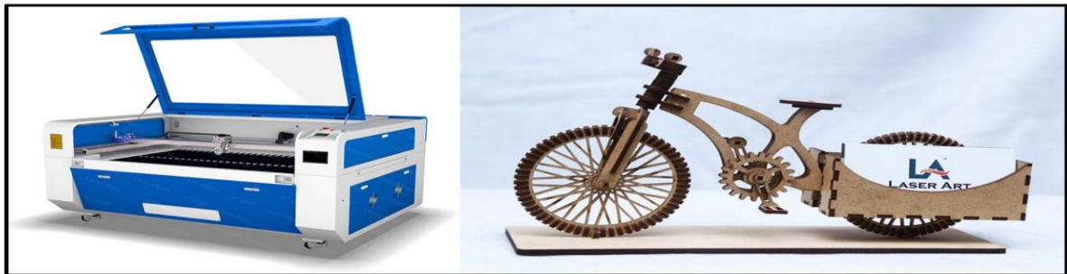
شكل ٦ : يوضح ماكينة الليزر وأحد منتجاتها
