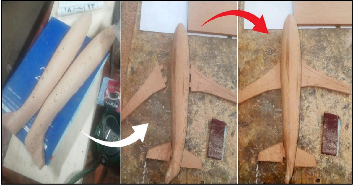
شكل ٢٢ : الطائرة بعد عمل جسمها الأساسي حفر cnc وبقية الأجزاء تقطع يدوي ثم التجميع
