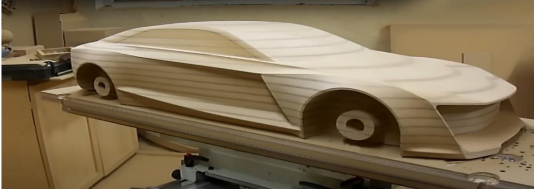
شكل ٢ : نموذج Layout Models لسيارة من الخشب
