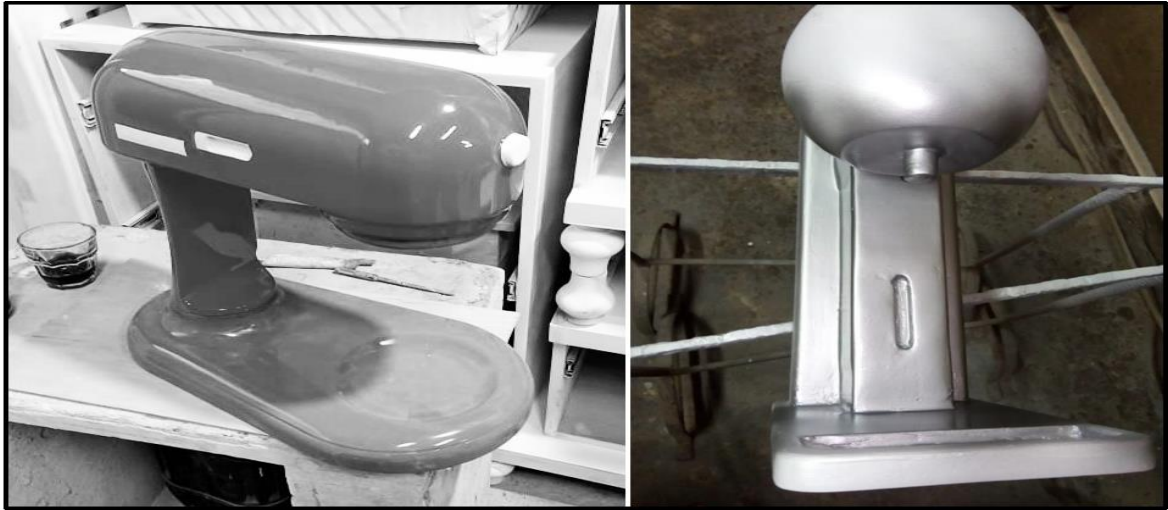
شكل ٢٧ : العجان، ماكينة القهوة بعد دهانهم بطبقة المعجون وتنعيم السطح بالصفرة ثالثاً: طلبة جامعة حلوان ( المكوك، ومكواة الشعر ): - تم طلاء المكوك ورنيش خشب عازل بدلاً من المعجون وتم الصفرة، أما مكواة الشعر فدهنت بمعجون فيلر (شكل ٢٧)
