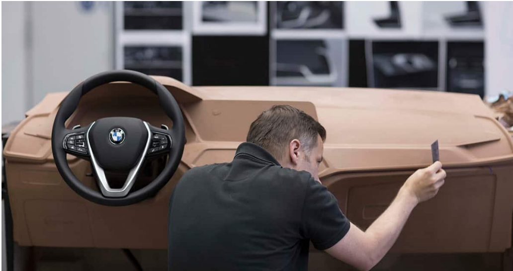
شكل ٣ : تصميم تابلوه السيارة BMW لعمل الاختبارات عليه
