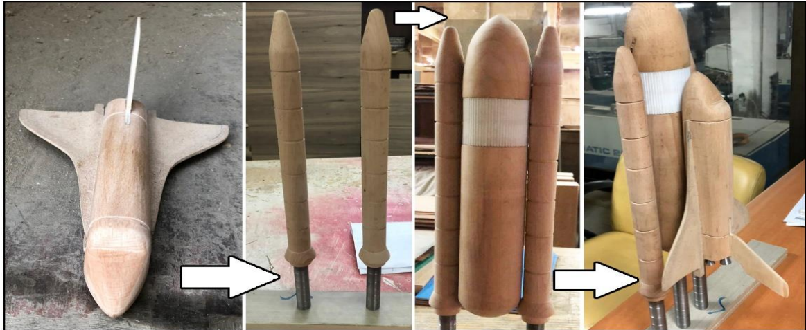
شكل ٢٥ : جسم المكوك بعد خراطة اجزاء منه، وباقي الأجزاء نحت يدوي
