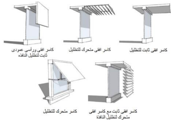
شكل (5) يوضح أنواع الكاسرات وعلاقة الكاسرة الأفقية بالواجهة، (على، 2019)
