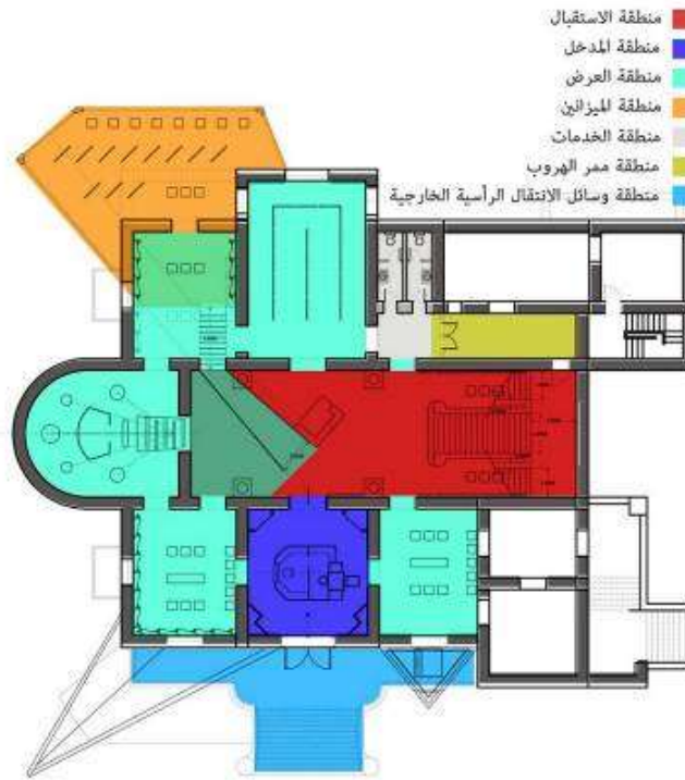
شكل 17 : صورة توضح قطاع أفقي يوضح توزيع المساحات للدور الأرضي ببرنامج ال Autocad المصدر : الباحث
