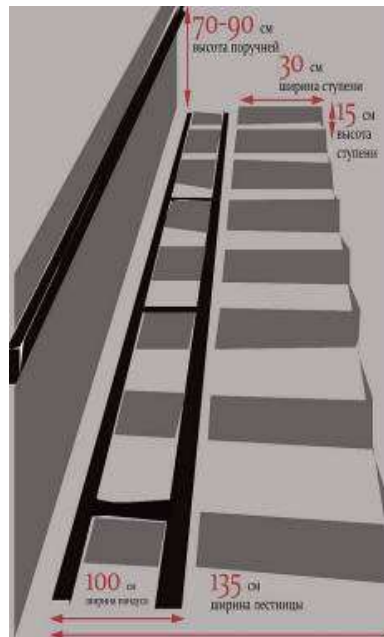
شكل 65 : صور توضح بعض تفاصيل المنحدر التلسكوبي المصدر : https://www.kalerampa.com/ar/ramp-what-is
