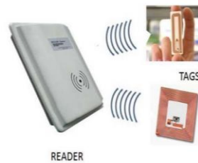
شكل (١) يظهر فكرة RFID (11:p1)
