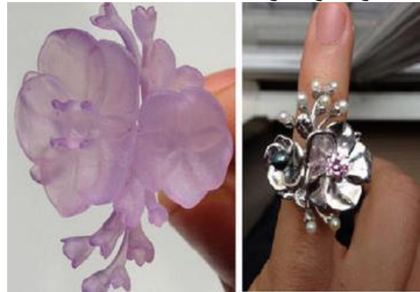
شكل (9) خاتم مصنوع من الترسيب الكهربائي على نموذج مصنع براتنج موصل للكهرباء
