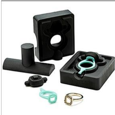
شكل (7) قالب دائم للنماذج الشمعية مصنع باستخدام البلمرة الضوئية
