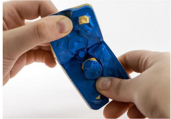
شكل (8) قالب من السيليكون تم تصنيعه على نموذج صلب أنتج بالتصنيع بالإضافة
