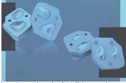
شكل (10) قوالب معدنية للتشكيل بالضغط مصنعة بتقنية صهر المسحوق
