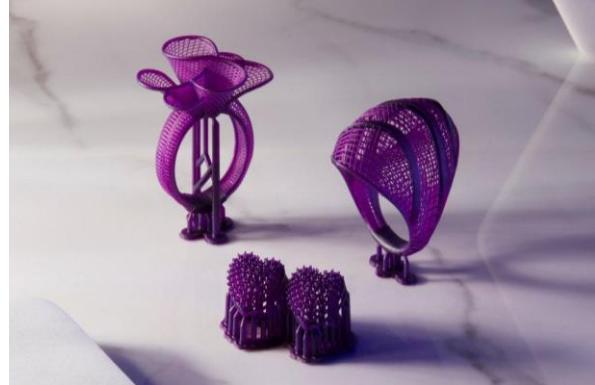
شكل (6) نماذج مصنوعة من راتنج الشمع القابل للسبك بتقنية البلمرة الضوئية
