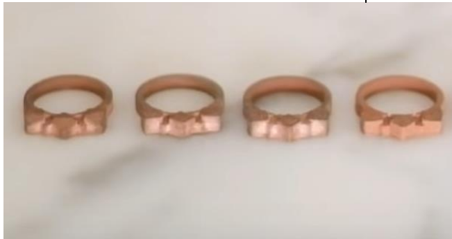
شكل (12) قطع من الحلي المصنوعة بتركيب مختلفة من الـ PLA المخلوط بالمعدن
