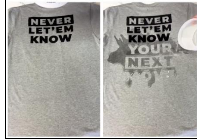
شكل (2) يوضح ظهور كتابات عند تعرض الخامة للإبتلال
