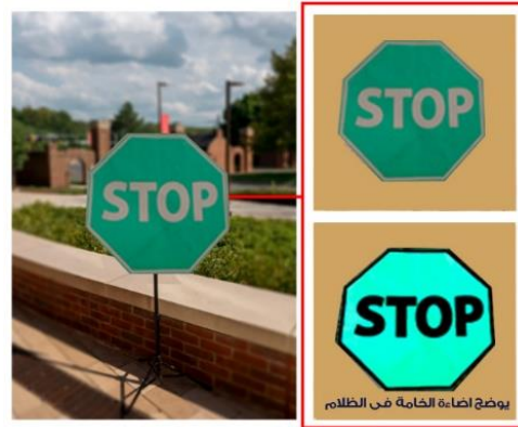
شكل (21) تغيير اللون عند تعرض الخامة لضوء الشمس
