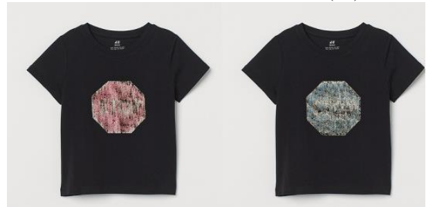
شكل (22) تغيير اللون عند تعرض الخامة لأشعة الشمس
