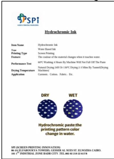
شكل (10) المواصفة المعتمدة بشركة SPI لتشغيل خامة الهيدروكروميك
