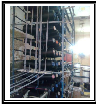
شكل (6) حامل خيوط اللحمة الخلفى شكل (7) أشربة الجومة قبل دخولها المشط لتوزيعها شكل (8) مطواه خيط السداء 2- الخامة المستخدمة (القماش):
