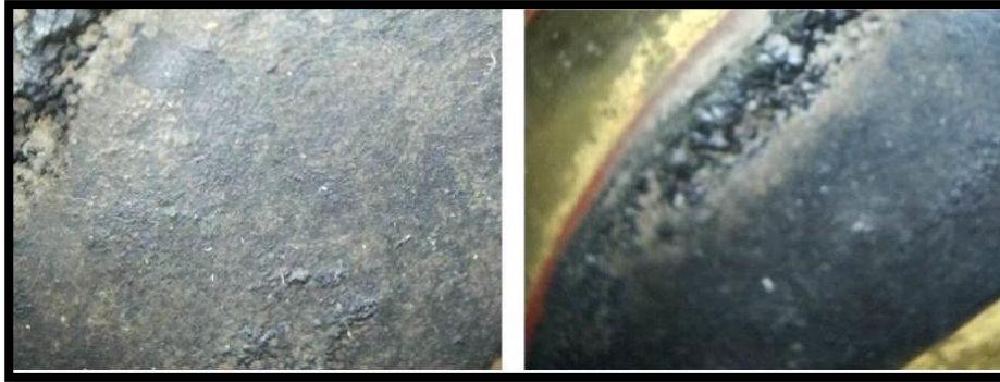
لوحة (16) توضح الفرق بين الحالة الجيدة وحالة البهتان بالمينا السوداء باستخدام USB digital microscope
