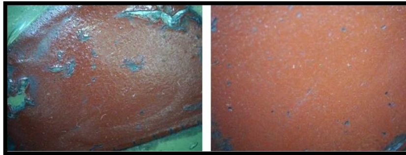
لوحة (17) توضح حالة المينا الحمراء بالمشكاة باستخدام USB digital microscope
