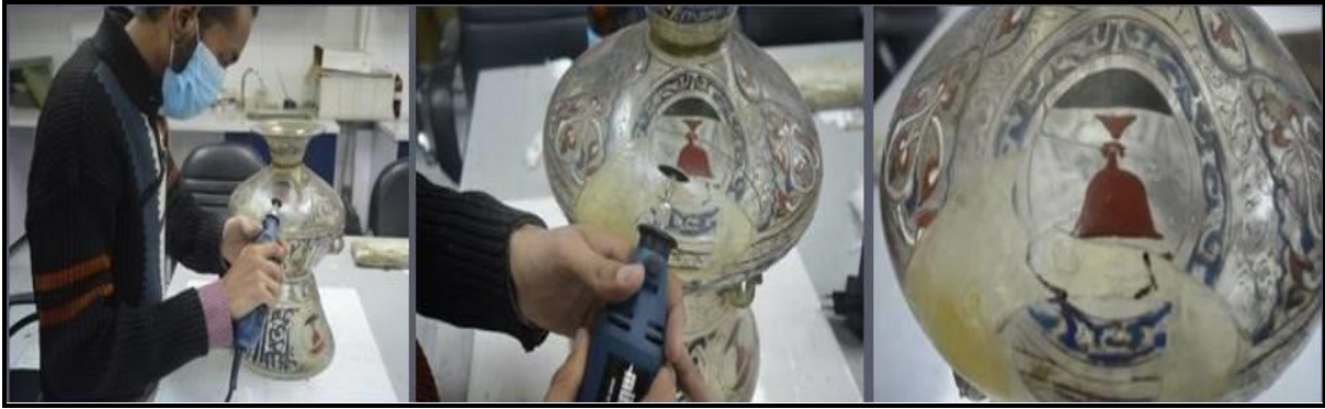
لوحة (23) توضح كيفية تفريغ مكان الكسرتين باستخدام الفريزة
