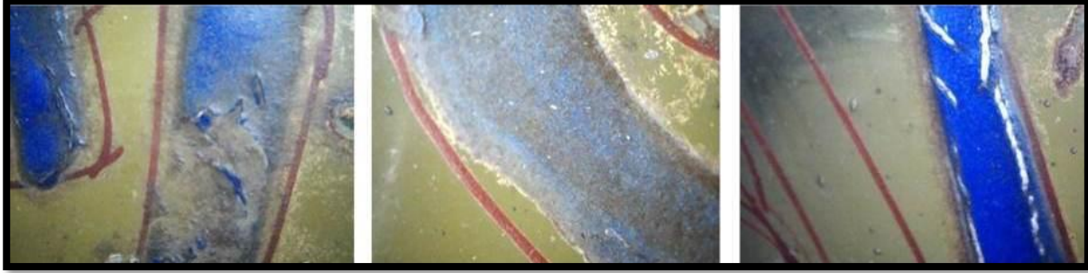
لوحة (15) توضح التلف المتدرج لبعض المينا الزرقاء بالمشكاة باستخدام USB digital microscope
