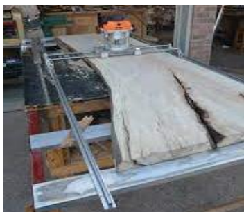
صورة ١٣: الصورة الكاملة لحركة الراوتر وآلية عمله بتسوية الخشب الغير مستوي والقديم
