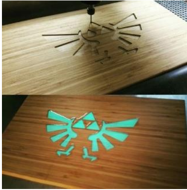
صورة ١٧: آلية عمل الراوتر لعمل مُسطح من الإيبوكسي والخشب
