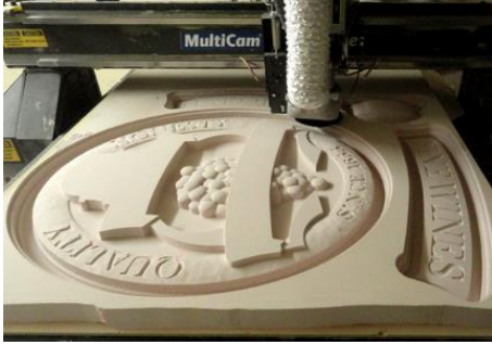
صورة ١: ماكينة الراوتر ثلاثية الأبعاد وحفرها بالخشب
