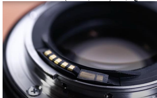
الشكل رقم (١٢) يوضح وضع شريط لاصق على نقاط التوصيل الكهربائية للعدسة
