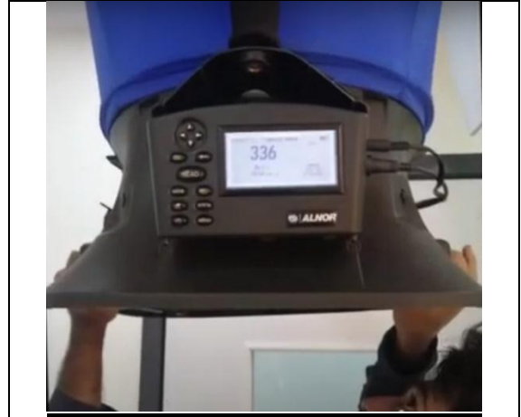
الشكل (٢٢-٢): اختبار تدفق الهواء والموازنة
