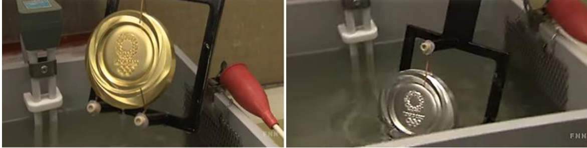
شكل (٣): الميدالية الأولمبية (Tokyo 2020) أثناء عملية الطلاء الكهربائي بمعدن الذهب فوق معدن الفضة [٤١].
