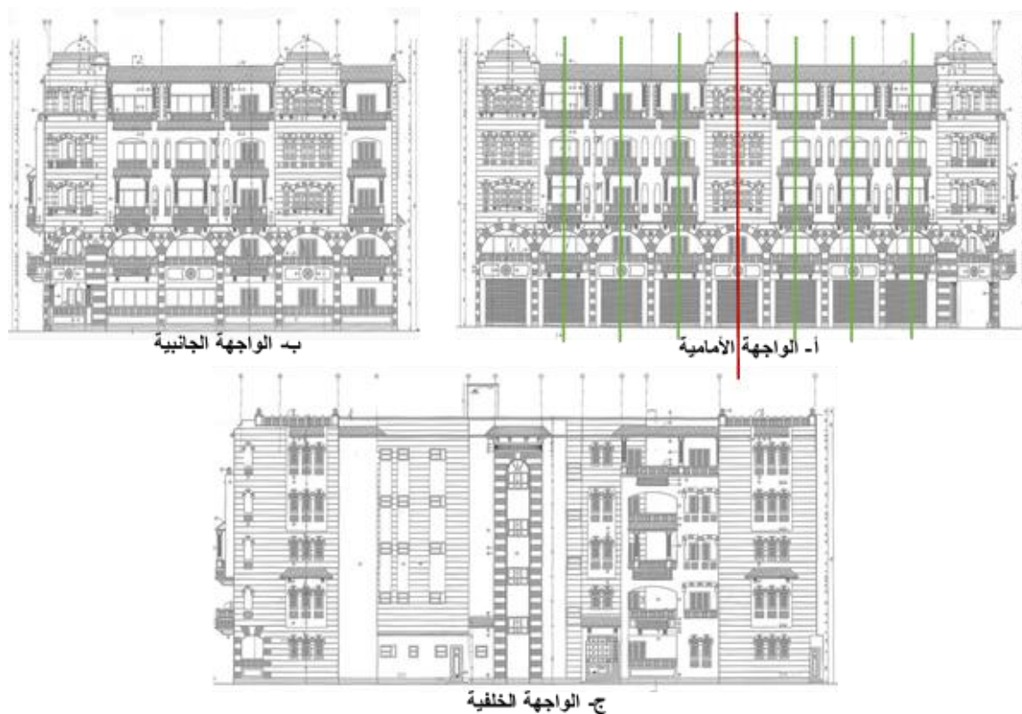
شكل (٤، ب، ج) نموذج التصميم المستخدم لتنفيذ مباني الكوربة الجديدة بمدينة هليوبوليس الجديدة.
