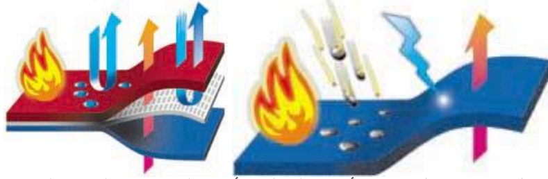
شكل (3) يوضح الفرق بين الأنسجة العازلة والأنسجة المرشحة في الملابس الوقائية
