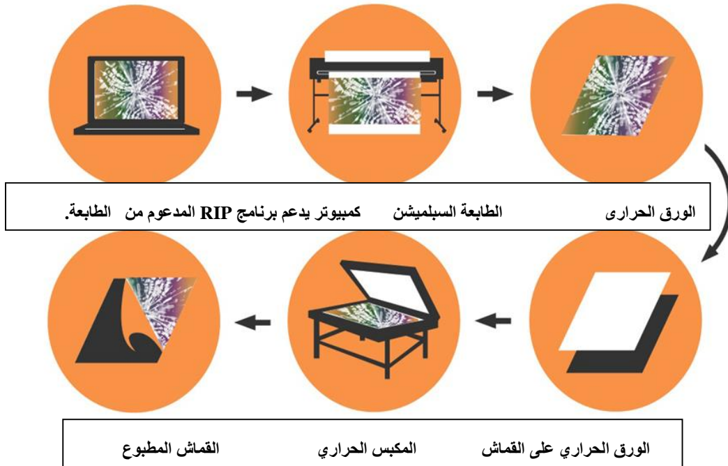
شكل رقم (١٣) يوضح المراحل التكنولوجية للطباعة بالانتقال الحراري على المنسوجات (السبلميشن)
