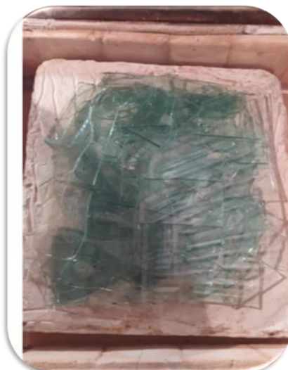
شكل(١٤) وضع الزجاج داخل القالب الحراري وحرقة داخل أفران حريق الزجاج الكهربائية.
