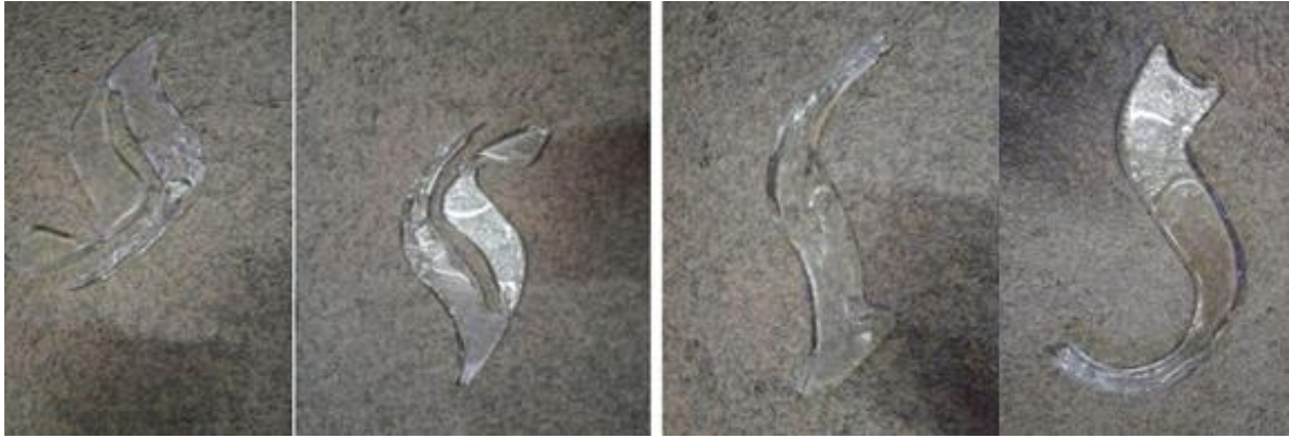
شكل (٢٧) يوضح الزجاج الناتج من صب المصهور الزجاجي داخل القوالب المعدنية المفرغة.
