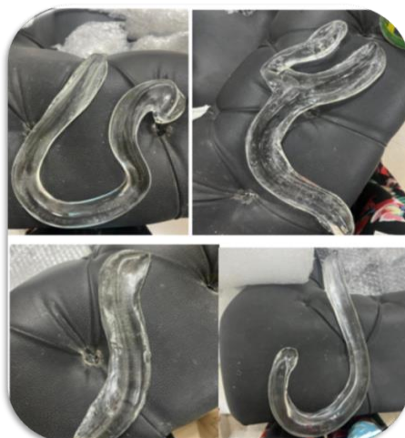
شكل (٢٢) الحروف الناتجة عن صب مصهور الزجاج بالقوالب الحرارية.
