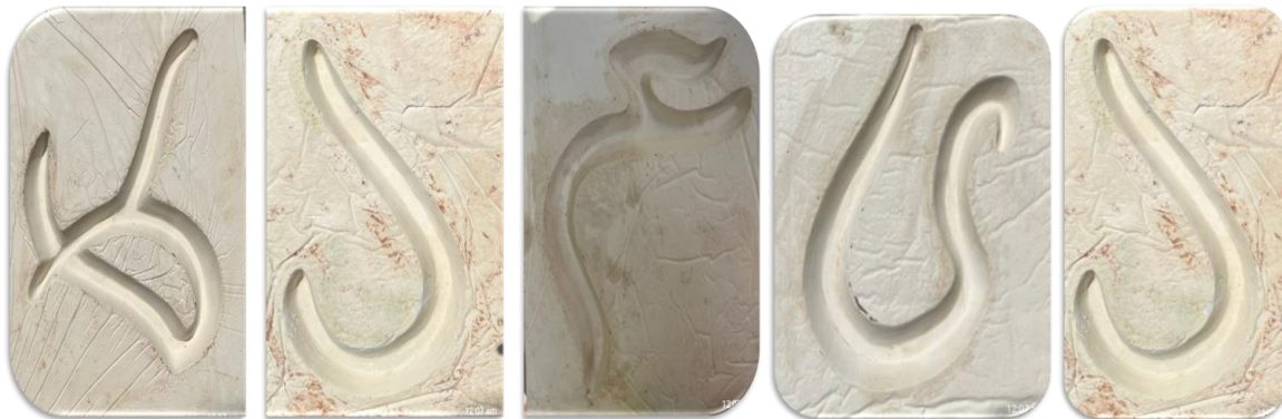
شكل (١٩) القوالب الحرارية لتشكيل الحروف بعد صبها على النماذج الطينية.
