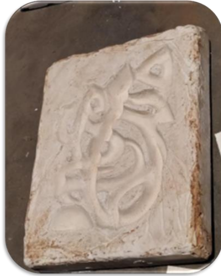
شكل (١٣) القالب الحراري بعد تفريغ من التشكيل الطمي.
