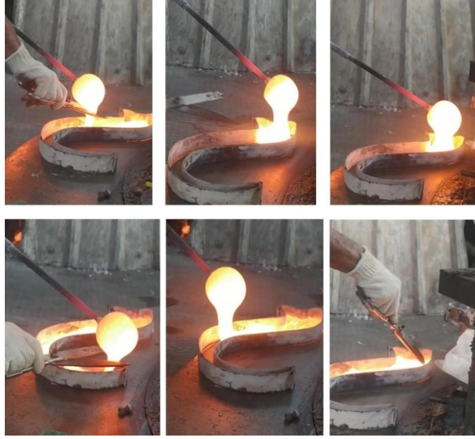
شكل (٢٦) يوضح صب المصهور الزجاجي داخل القوالب المعدنية المفرغة.
