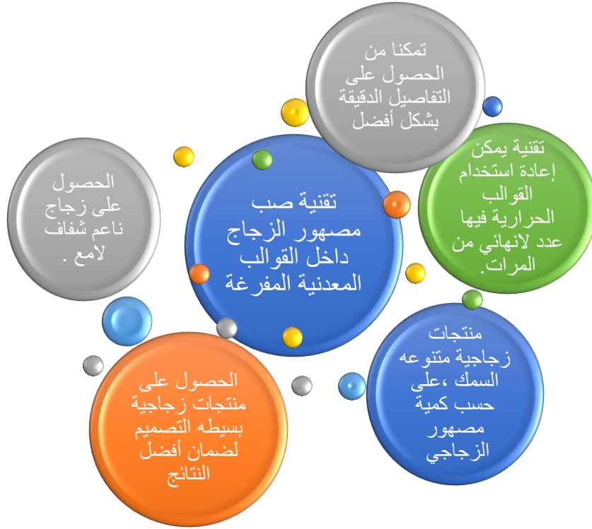
شكل (٢٩) يوضح نتائج تقنية صب مصهور الزجاج داخل القوالب المعدنية المفرغة.
