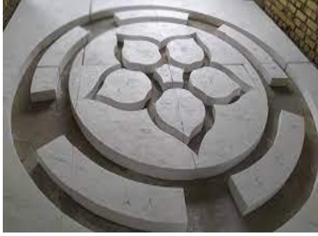
قالب بخامة الفلين - تقنية الصب
