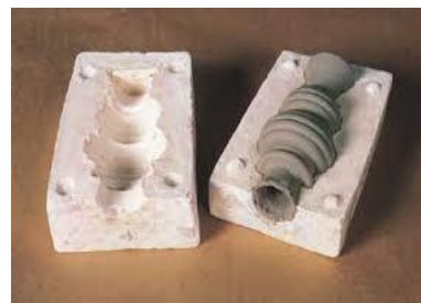
قوالب بخامة الجص - تقنية الصب
