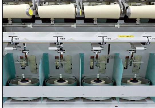
شكل (2) جزء من ماكينة الزوي المدمج SAVIO TVS Compact Twister M/C (ماكينة التجارب العملية) (15)
