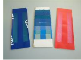
شكل (20) المقياس الأزرق لتقييم ثبات اللون للضوء
