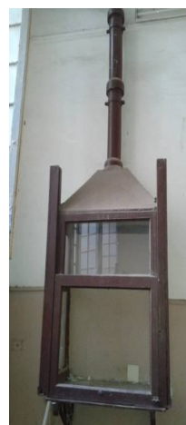
لوحة رقم ( 25 ) ساحب أو شفاط Fume Hood للغازات والأبخرة المتصاعدة من التفاعلات الكيميائية الضارة مصنوعة من الحديد تصوير الباحث
