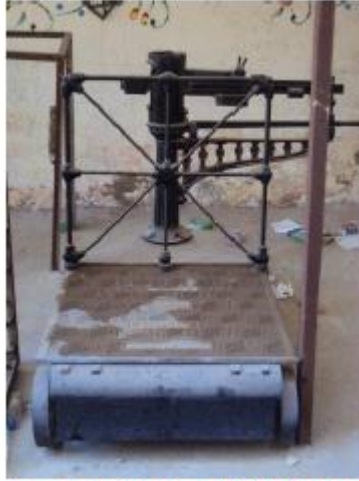
لوحة رقم (٣٩) أول ميزان استخدم في المدرسة منذ عصر الإنشاء لوزن الحديد والخشب. ( تصوير الباحث )
