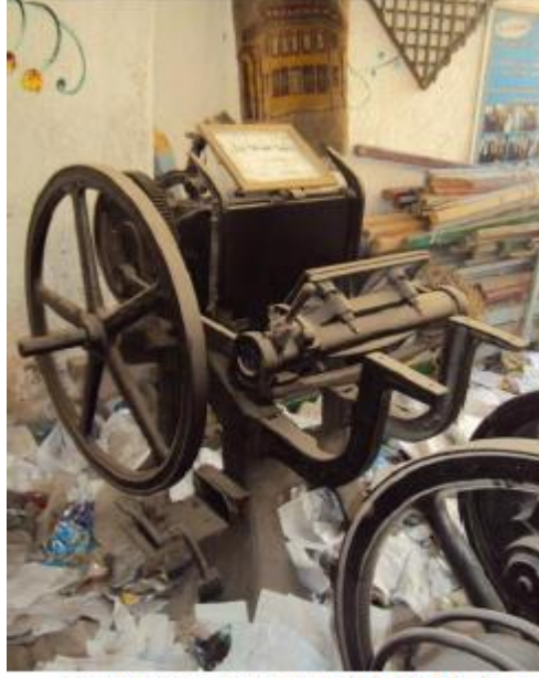
لوحة رقم (٤٤) ماكينة طباعة بدال كانت تستخدم للطباعة البارزة.
