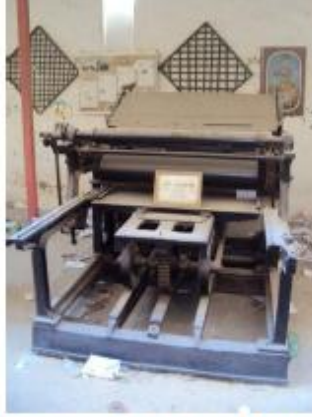
لوحة رقم (٤٢) ماكينة طباعة بارزة فينكس (بدال) تستخدم لعملية الطباعة. ( تصوير الباحث )
