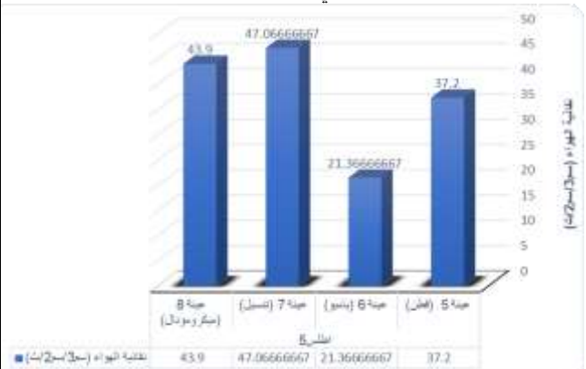
شكل (19) نتائج اختبار نفاذية الهواء علي العينات المنتجة بالتركيب اطلس 5
