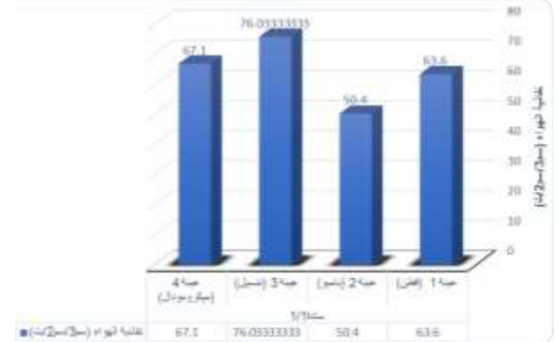
شكل (18) نتائج اختبار نفاذية الهواء علي العينات المنتجة بالتركيب سادة 1/1
