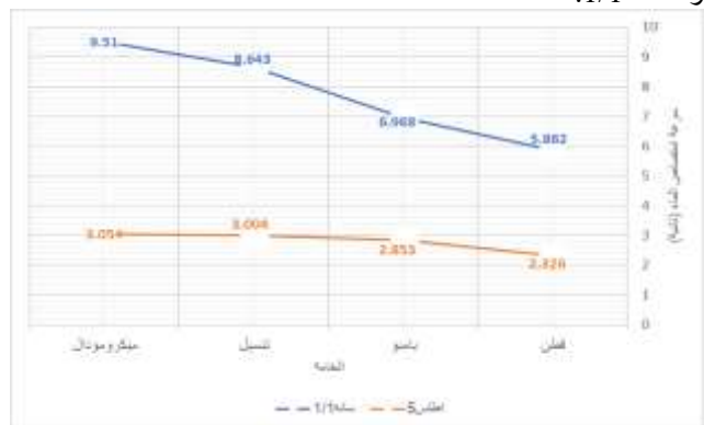
شكل (14) نتائج اختبار سرعة امتصاص الماء علي العينات المنتجة بالتركيب السادة 1/1 و اطلس 5
