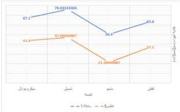
شكل (20) نتائج اختبار نفاذية الهواء علي العينات المنتجة بالتركيبين السادة 1/1 و اطلس 5
