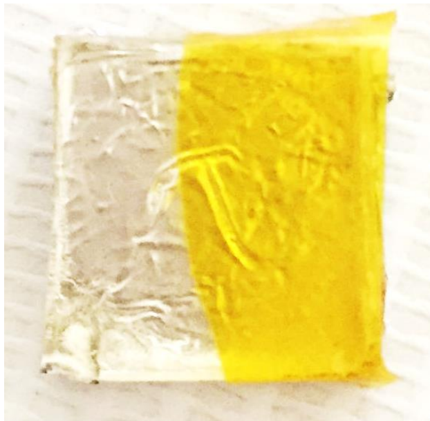
Fig. 2 The Kapton-PMMA button.
