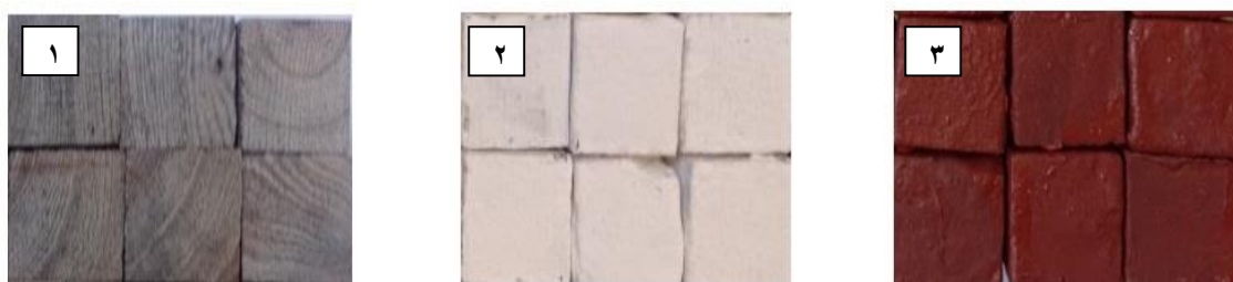
شكل رقم (١-١) يوضح تجهيز العينات الخشبية، (٢-١) العينات الخشبية بعد تطبيق أرضية تحضير، (٣-١) العينات بعد التلوين بالمغرة الحمراء.
