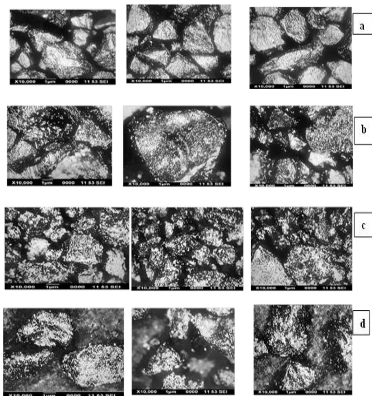
**Fig. 3:** Scanning Electronic Microscope (SEM) of (a) AgNPs (b) CuNPs (c) MnNPs (d) NiNPs.
