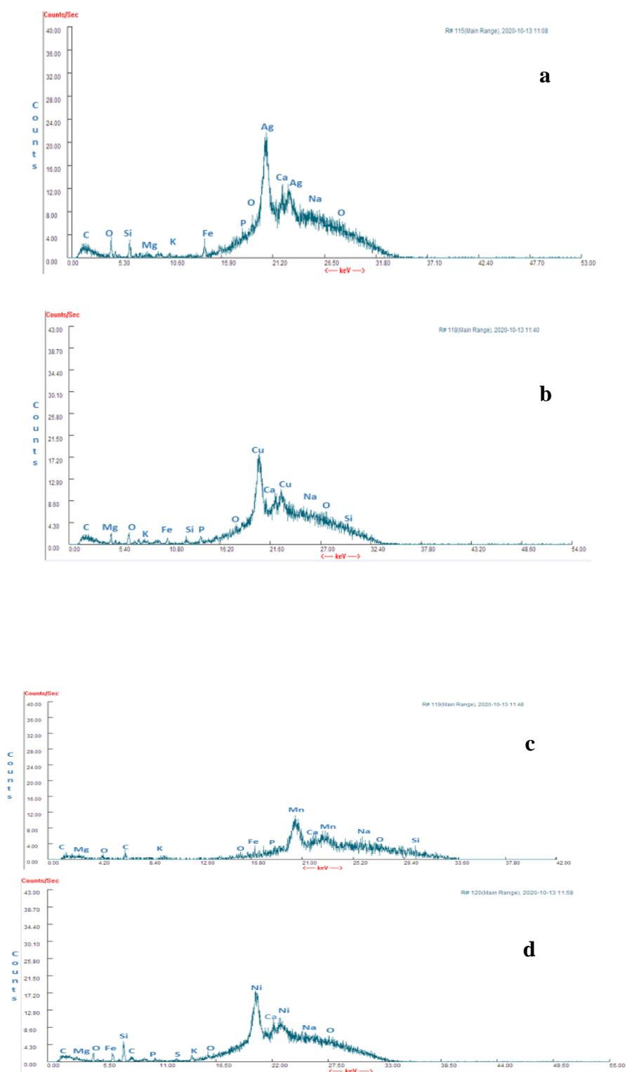
**Fig. 4:** EDX spectrum of (a) AgNPs (b) CuNPs (c) MnNPs (d) NiNPs.
