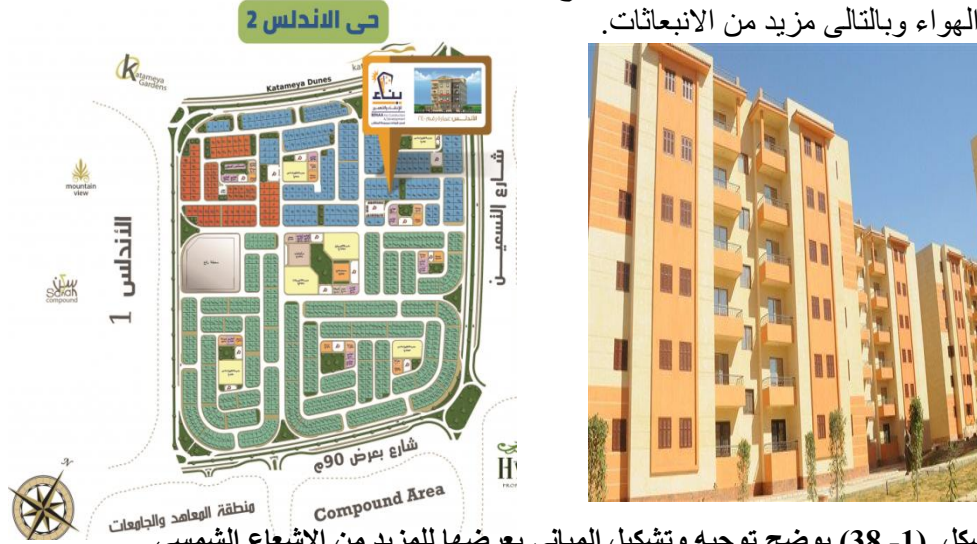
شكل (1- 38) يوضح توجيه وتشكيل المباني يعرضها للمزيد من الإشعاع الشمسي . المصدر: تصوير الباحث - جهاز القاهرة الجديدة .
