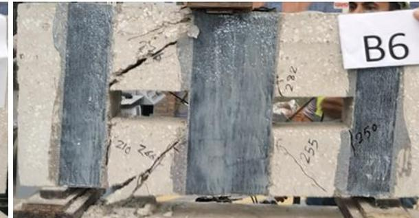
B6-RO-H-F : Diagonal-shear splitting
