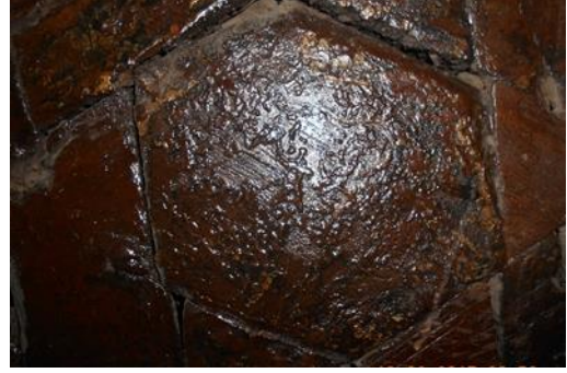
شكل (8) يوضح تلف وتجعده طبقة الورنيش الحديث
