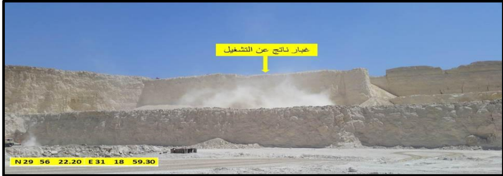
صورة (٧) الأتربة المتصاعدة أثناء إزاحة طبقات الغطاء بمحجر الحجر الجيري بوادي طره
