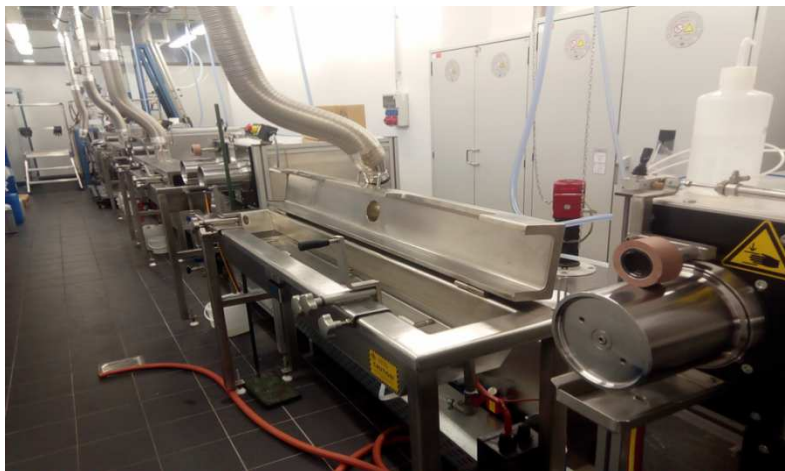
شكل (١): ماكينة الغزل الرطب المستخدمة بالبحث والأجزاء الملحقة بها
